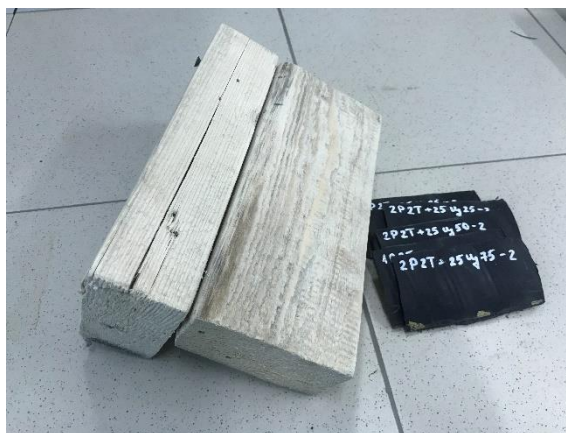
Рис. 4.3.2. Деревянный уголок для испытания методом изгиба на 90^\circ
