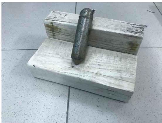
Рис. 4.3.3. Металлический груз для испытания методом броска груза
